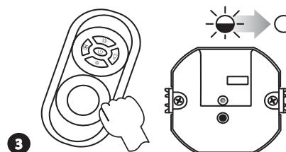
Отпустить кнопку включить/выключить пульта управления Р-260. Зажжется (пульсирующий сигнал), а затем потухнет красный диод STATUS в светильнике
