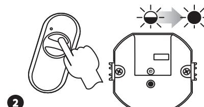
Нажать и отпустить первую выбранную кнопку передатчика (ON). Зажгется (пульсирующий, а затем постоянный сигнал) красный диод STATUS - ПЕРЕДАТЧИК СОХРАНЕН
