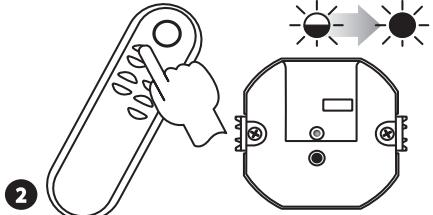
Нажать и затем отпустить кнопку «1» пульта управления Р-256/8. Зажжется (пульсирующий, а затем постоянный сигнал) красный диод STATUS в светильнике
