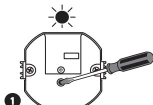
Нажать кнопку PROG в светильнике и удерживать ее до момента зажжения (постоянный сигнал) красного диода STATUS
