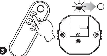
Нажать и затем отпустить кнопку «2» пульта управления Р-256/8. Зажжется (пульсирующий сигнал), а затем потухнет красный диод STATUS в светильнике
