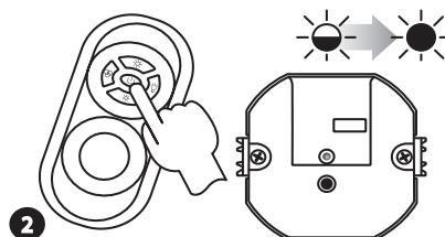
Нажать и удержать кнопку включить/выключить пульта управления Р-260. Зажжется (пульсирующий, а затем постоянный сигнал) красный диод STATUS в светильнике
