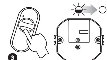
Нажать и отпустить вторую выбранную кнопку передатчика (OFF). Зажгется (пульсирующий сигнал), а затем потухнет красный диод STATUS - ПЕРЕДАТЧИК СОХРАНЕН
