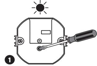
Нажать кнопку PROG в светильнике и удерживать ее до момента зажжения (постоянный сигнал) красного диода STATUS в светильнике
