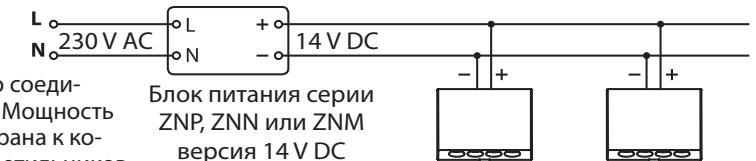
Схема 1. Параллельно соединенные светильники. Мощность блока питания подобрана к количеству питаемых светильников.
