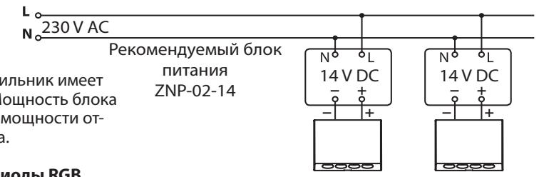
Схема 2. Каждый светильник имеет отдельное питание. Мощность блока питания подобрана к мощности отдельного светильника.
