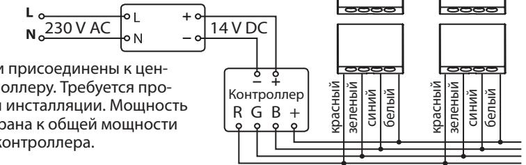
Схема 4. Светильники присоединены к центральному RGB-контроллеру. Требуется проведение 4-проводной инсталляции. Мощность блока питания подобрана к общей мощности светильников и RGB-контроллера.
