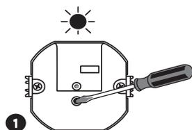
1 Нажать кнопку PROG в светильнике и удерживать ее до момента загорания (постоянный сигнал) красного диода STATUS
