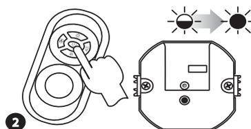
2 Нажать и удерживать кнопку включить/выключить пульта управления P-260. Зажжется (пульсирующий), а затем постоянный сигнал красный диод STATUS в светильнике
