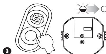
3 Отпустить кнопку включить/выключить пульта управления P-260. Зажжется (пульсирующий) сигнал, а затем потухнет красный диод STATUS в светильнике
