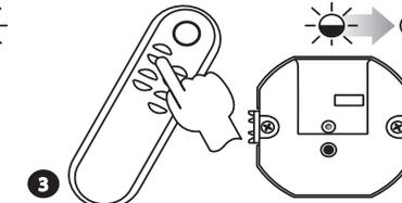
3 Нажать и затем отпустить кнопку «2» пульта управления P-256/8. Зажжется (пульсирующий) сигнал, а затем потухнет красный диод STATUS в светильнике
