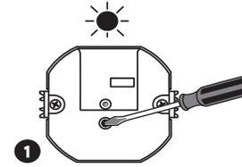
1 Нажать кнопку PROG в светильнике и удерживать ее до момента загорания (постоянный сигнал) красного диода STATUS
