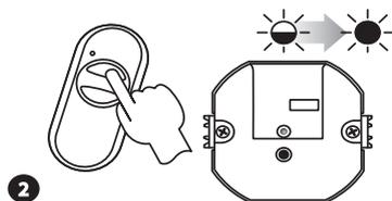
2 Нажать и отпустить первую выбранную кнопку передатчика (ON). Зажжется (пульсирующий, а затем постоянный сигнал) красный диод STATUS
