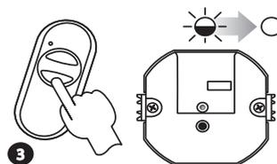
3 Нажать и отпустить вторую выбранную кнопку передатчика (OFF). Зажжется (пульсирующий сигнал), а затем потухнет красный диод STATUS - ПЕРЕДАТЧИК СОХРАНЕН
