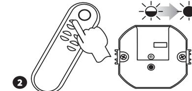
2 Нажать и затем отпустить кнопку «1» пульта управления P-256/8. Зажжется (пульсирующий), а затем постоянный сигнал красный диод STATUS в светильнике
