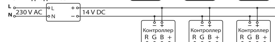
Схема 3. Каждый светильник соединен с отдельным RGB-контроллером. Возможно подключение к типичной 2-проводной инсталляции. Мощность блока питания подбрана к общей мощности светильников и контроллеров.
