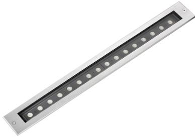
FALLS est un diffuseur intégré et transparent parfait pour toutes sortes de projets. Il est doté d'un indice de protection IP65 qui lui confère une protection élevée contre la pluie et les corps solides. Option à orienter et 18W. L'option 30x60° permet un éclairage asymétrique.
