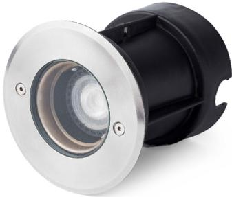
Encastré de sol pour éclairer les jardins et les terrasses, en acier inoxydable 316 et verre. Boîtier encastrable inclus. Cette lampe encastrable est idéale pour créer des balises lumineuses le long des parcours pour espaces extérieurs. Ce luminaire extérieur a un IP67, c'est un indice de protection élevé contre la pluie et les corps solides. Résistance aux coups IK08. Permet le passage de charge jusqu'à 2000Kg.
