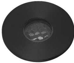
Encastré de sol LED 2W pour éclairer les jardins et les terrasses. Cette lampe encastrable LED est idéale pour créer des balises lumineuses le long des parcours en espaces extérieurs. Ce luminaire extérieur noir a un IP67, c'est un indice de protection élevé contre la pluie et les corps solides. Résistance aux coups IK08. Permet le passage de charge jusqu'à 1000Kg.
