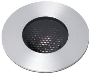
Encastré de sol LED 13W pour éclairer les jardins et les terrasses. Cette lampe encastrable LED est idéale pour créer des balises lumineuses le long des parcours en espaces extérieurs. Ce luminaire extérieur a un IP67, c'est un indice de protection élevé contre la pluie et les corps solides. Résistance aux coups IK08. Permet le passage de charge jusqu'à 1000Kg.
