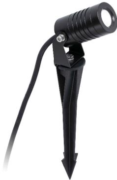
Proyector LED con estaca de luz cálida para exteriores fabricado en aluminio con difusor de cristal transparente. La fuente de iluminación es HIGH POWER LED 3W 3000K 130Lm 30° CRI>80. Este proyector orientable es ideal para la iluminación del jardín y le permitirá realzar elementos decorativos. Esta luminaria cuenta con IP67 que le otorga una alta protección contra la lluvia y los cuerpos sólidos.
