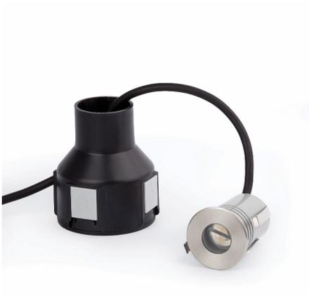
CURTIS es un empotrable asimétrico con tecnología LED para iluminación exterior y luz cálida, fabricado en acero inoxidable 316 y aluminio con difusor de cristal templado. Incluye la caja de ABS para empotrar. La fuente de iluminación es HIGH POWER LED 2W 3000K 77Lm. Tiene una resistencia a los golpes de IK08. Permite el paso rodado hasta un máximo de 1400Kg. Este empotrable de exterior es ideal para bañar la pared.
